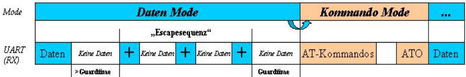
Abbildung: Datenfluss beim BT-PlugA3 im Daten-Mode
